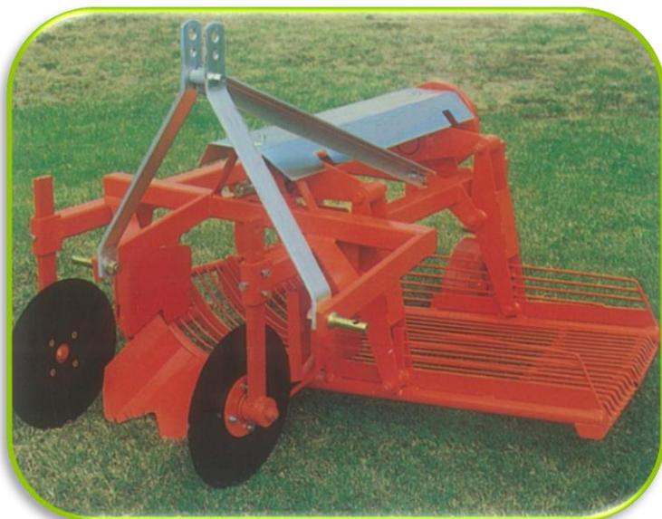
Scava patate con scarico laterale
